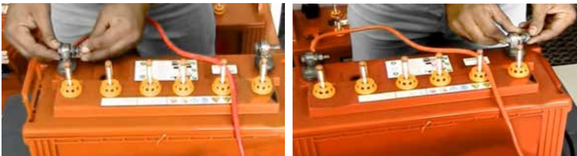
चित्र 3.1.9: बैटरी टर्मिनलों को कनेक्ट करें
