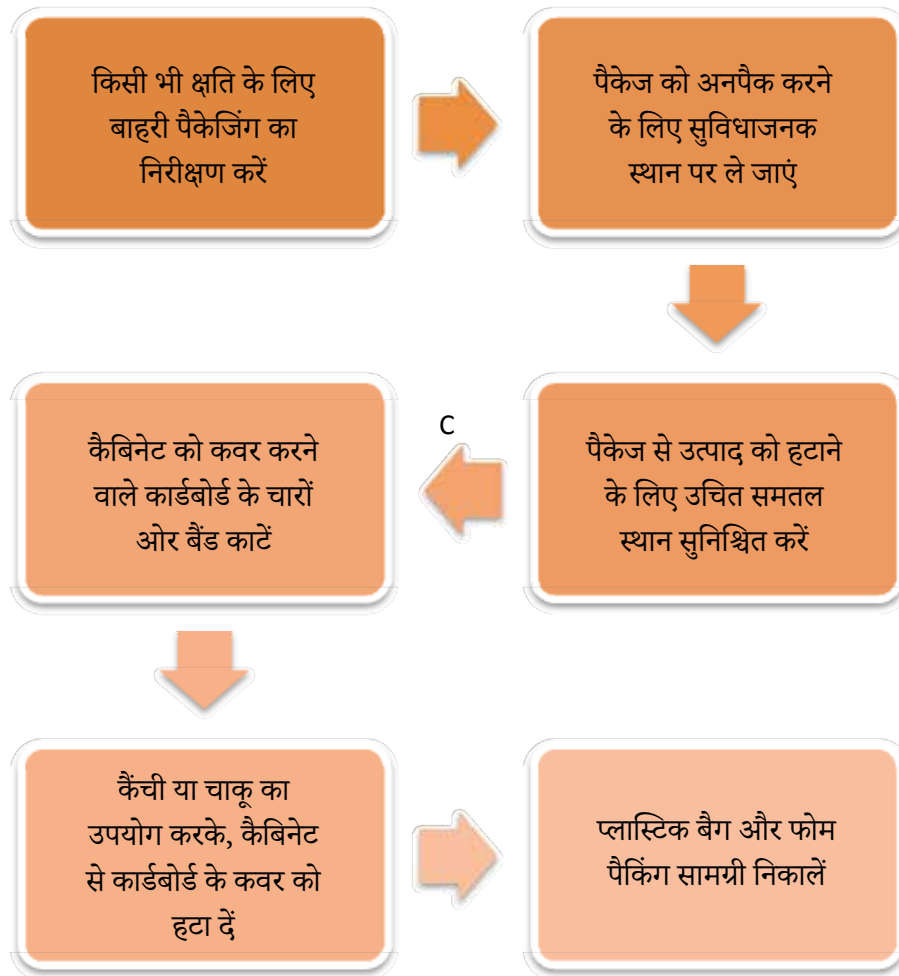
चित्र 3.1.3: यूपीएस/इन्वर्टर को खोलने के फेस
