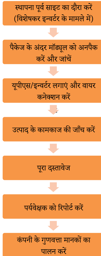
चित्र 3.1.1: यूपीएस/इन्वर्टर स्थापित करने के लिए कार्यप्रवाह
