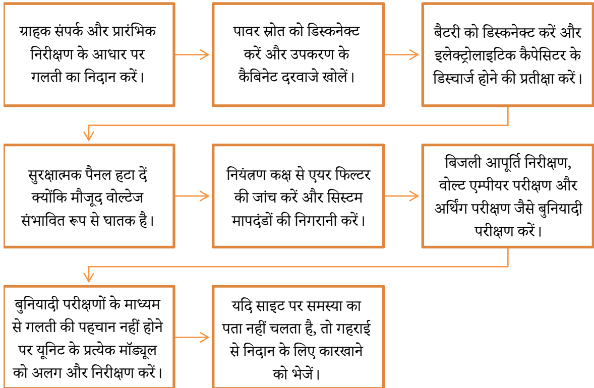
चित्र 3.2.3: यूपीएस/इन्वर्टर में खराबी की पहचान करने के लिए लक्षणों को समझने के लिए कार्यप्रवाह
