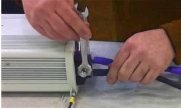
चित्र 3.1.10: इन्वर्टर में लीड संलग्न करें
